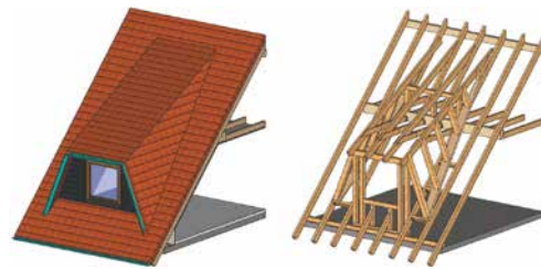
Bild 6: Trapezgaube Quelle: Grundwissen moderner Holzbau
