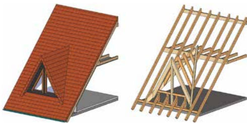
Bild 5: Dreiecksgaube Quelle: Grundwissen moderner Holzbau
